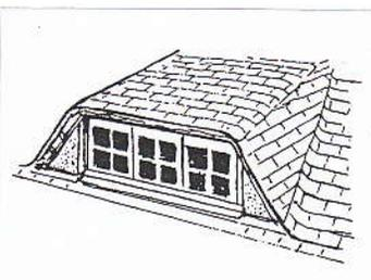
lucarne en **trapèze** (couverture en bardeaux d'asphalte)
